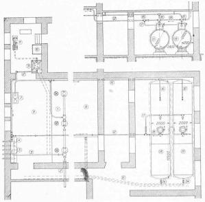
Abb. 7. Grundriss des Kesselhauses. — 1:250.
