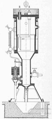
Abb. 1. Elektrischer Revel-Kessel. Schnitt 1:25.
