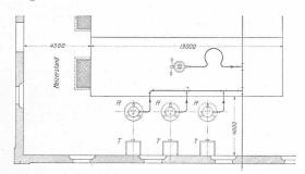
Abb. 5. Anorduung einer Batterie von Revelkesseln mit 2100 kW Gesamtleistung im bestehenden Kesselhaus. — Masstab 1:250.
