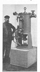
Abb. 2. Elektrischer Revel-Kessel für kleine Leistung.
