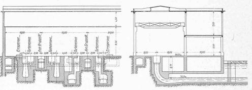
Abb. 27. Längsschnitt und Querschnitt des Maschinenhauses. - Masstab 1:500.
