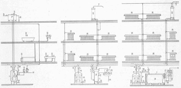
Abb. 4. Elektrische Warmwasserbereitungsanlage.
