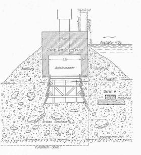
Abb. 12. Pneumatischer Fundations-Vorgang. — 1:150.
