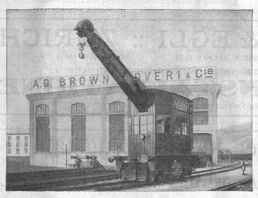
Lokomotiv-Drehkran mit Akkumulatorenbetrieb für den Werkstättenund Verladedienst.
