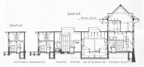
Abb. 129. Schnitte durch die Schaltanlage des Kraftwerks Gösgen. - Massfab 1:400.
