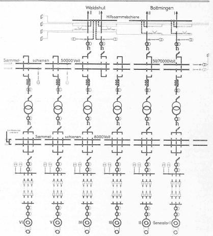
Abb. 126. Einpoliges generelles Schaltungschema des Kraftwerks Gösgen (linke Hälfte).
