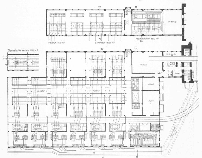
Abb. 128. Grundrisse des Schalthauses des Kraftwerks Gösgen. - Masstab 1:400.
