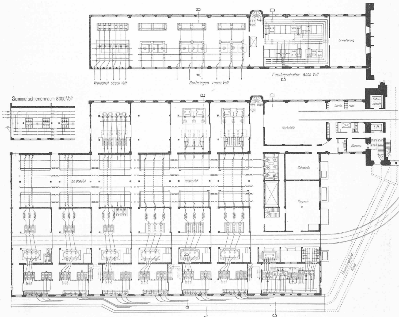
Abb. 128. Grundrisse des Schalthauses des Kraftwerks Gösgen. — Masstab 1:400.
