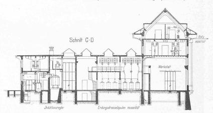
Abb. 130. Schnitt durch die Schaltanlage. - Masstab 1:400.
