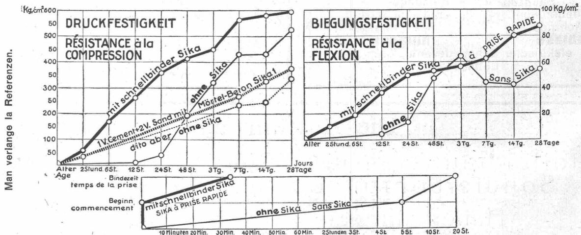
Die Probekörper wurden von der Anstalt selbst angefertigt. **Wasserdruck-Proben:** Bei Maximaldruck des Apparates (8 Atm.) blieben die Proben trocken. Mit schnellbindender SIKA kann während grossem Wasserdruck abgedichtet werden, selbst mittels Anstrichen.
