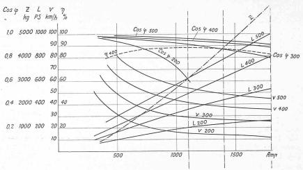
Abb. 14. Charakteristische Kurven eines Triebmotors [Leistung L, Wirkungsgrad  $\eta$  und Leistungsfaktor cos  $\varphi$ , sowie Zugkraft Z am Radumfang und Geschwindigkeit v] bei Klemmen-Spannungen von 200, 300, 400 (normal) und 500 V und 14,3 Per.
