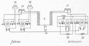
Abb. 21. Generelles Schema der Fahr- und Bremsschaltung der Triebmotoren.
