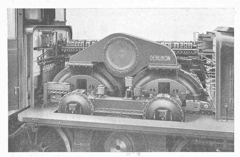
Abb. 10. Abgedeckter Lokomotiv-Vorbau mit Triebmotorengruppe nebst Fahrtwendern und Ventilator.
