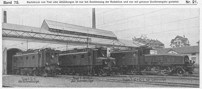
Abb. 1. Probe-Schnellzuglokomotiven 1C1 und 1B+B1, sowie Güterzuglokomotive 1C+C1 der Maschinenfabrik Oerlikon vor dem Lokomotivdepot Bern,
