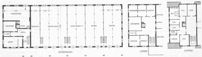
Abb. 3 bis 6. Erdgeschoss-Grundriss, Teilgrundrisse vom 1. und 2. Stock und Schnitt des Zeughauses in Herisau. — Masstab 1:500,
