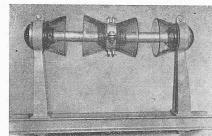
Abb. 8. Glocken- und Diabolo-Isolatoren aus Glas.
