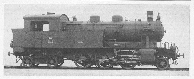
Abb. 2. Heissdampf-Tenderlokomotive der Portugiesischen Staatsbahnen. - Gebaut von der Schweizer, Lokomotiv- und Maschinenfabrik Winterthur,
