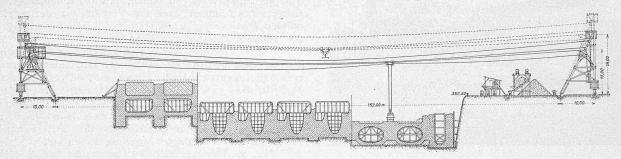
Abb. 107. Längsschnitt durch die Baugrube mit den Kabelbahnen, von Westen betrachtet. - Masstab etwa 1:1000.
