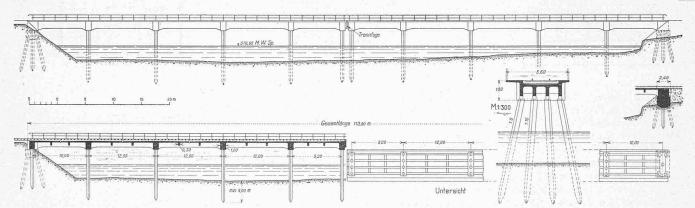
Abb. 108 und 109. Gesamtbild, sowie Ansichten und Schnitte 1:600 bezw. 1:300 der Aarebrücke bei Däniken für das Anschlussgeleise des Kraftwerks Gösgen.
