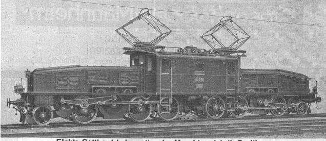
Elektr. Gotthard-Lokomotive der Maschinenfabrik Oerlikon
