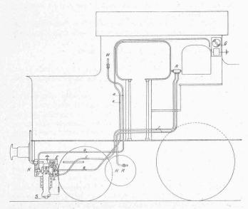
Abb. 3. Anordnung des Warnungsignal-Apparats auf der Lokomotive.
