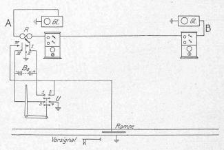
Abb. 5. Stromlaufschema für eingeleisige Bahn.
