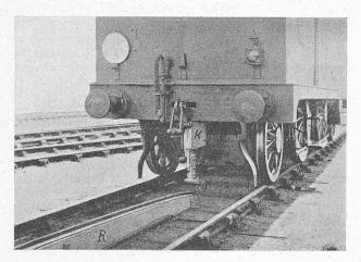
Abb. 2. Gleitkontakt unter dem Führerstand der Lokomotive
