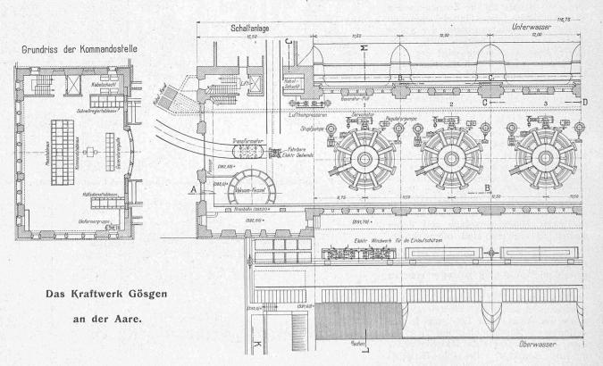
Abb. 77. Grundriss des Maschinenhauses (nördliche Hällfte); links Grundriss des Kommandoraumes im Turm. — Masstab 1:400.
