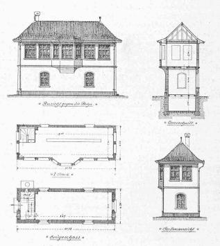
Abb. 8. Stellwerkhäuschen der S. B. B. im Bahnhof Baden. Ansichten, Grundrisse und Schnitt.
