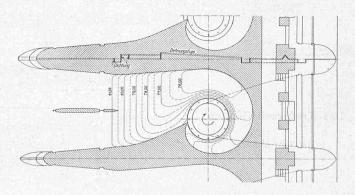
Abb. 82. Horizontalschnitt (mit Höhenkurven) durch die Einlaufspirale. - Masstab 1:400.
