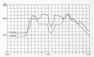
Abb. 2. Täglicher Verlauf der Belastung des E.-W. Basel.
