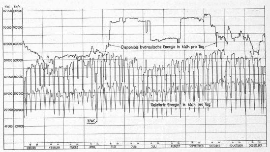
Abb. 3. Verlauf der hydraulisch disponibeln und der abgegebenen Energie im Netz der Bernischen Kraftwerke im Jahre 1919.
