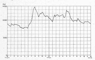
Abb. 1. Täglicher Verlauf der Belastung des E.-W. Zürich.
