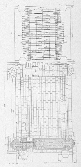
Abb. 11. Pfeileransicht mit Schnitt durch Schwelle und Dienstbrücke. — 1:250. — Abb. 12. Grundriss und Armierung der Wehrschwelle und Pfeilerschmitt.
