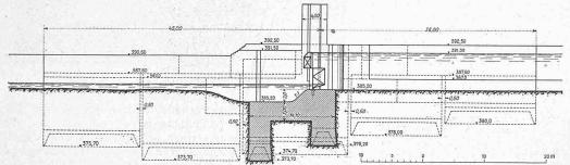
Abb. 10. Schnitt durch Oeffnung 1 mit Ansicht der rechtsseitigen Ufermauer (deren Caissons gestrichelt). - 1:600.
