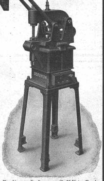
Maschine zum Erwärmen von 40-50 Nieten (Durchmesser bis 25 mm, Schaftlänge bis 120 mm) pro Stunde. Stromverbrauch 8-10 kW.
