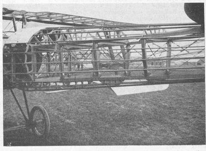
Abb. 16. Gerippe zum Fournier-Rumpf des oben dargestellten Flugapparates.
