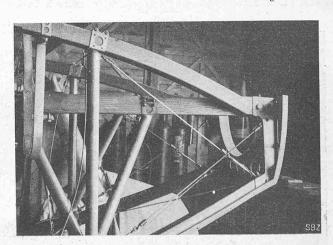
Abb. 14 und 15. Gitterträger-Flugzeugrumpf, rechts vor, links nach dem Einbau des Motors.
