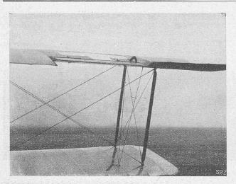
Abb. 22. Flügelpaar mit Verwindungsklappe an dem obern Flügel.
