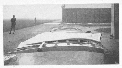
Abb. 19. Tragslächen-Gerippe eines Flugapparates.
