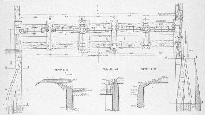
Abb. 9. Grundriss des Stauwehres und Schnitte der Unterwasser-Flügelmauern. — Masstab 1:600.
