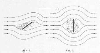
auch Luftwiderstandsfaktor; er ist bei jedem Körper, für dessen Seiten- und Oberflächenverhältnis und dessen Stellung verschieden. Der spezifische Luftwiderstand  $\zeta_w\cdot \frac{\gamma}{g}$  ist der Luftwiderstand in kg für i  $m^2$  Fläche bei i m Luft-Geschwindigkeit in Luft von bestimmter Temperatur und bekanntem Barometerstand. Er wird in der Literatur gewöhnlich mit k bezeichnet und hat die gleiche Bedeutung wie der Erfahrungswert c in der Hydrodynamik.
