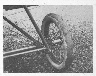
3 Abb. 10. Abfederung der Radachse mittels Gummibändern.
