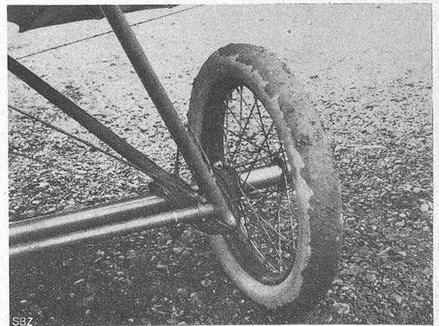
Abb. 10. Abfederung der Radachse mittels Gummibändern.
