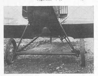
Abb. 9. Fahrgestell mit Luftreifen-Rädern.
