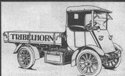
Lastwagen für 600 bis 5000 Kilos Tragkraft.
