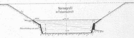
Abb. 58. Oberwasserkanal des Kraftwerkes "Gösgen" an der Aare. Normalprofil im Felseinschnitt, Km. 3,3 bis 4,8. – Masstab 1:500.
