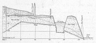
Abb. 69. Wasserversorgung von Ober- und Niedergösgen. Längenprofil bei Km. 2,8 des Oberwasser-Kanals, Masstab für die Längen 1:3500, für die Höhen 1:700.
