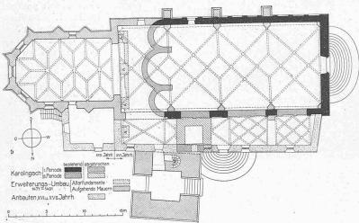
Abb, 1. Baugeschichtlicher Grundriss der St. Martinskirche in Chur. - 1:400.
