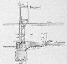
Abb. 40 und 41. Hauptjoch und Nebenjoch des Kanal-Einlaulbauwerks und Schnitt durch die Schwelle. - 1:300.
