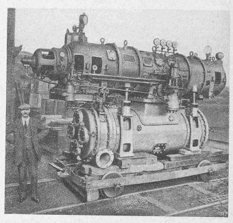
Abb. 2. Ljungström-Turbogeneratorgruppe auf den Kondensator aufgebaut.
