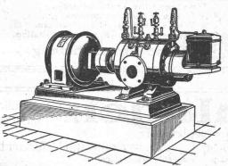
Direkte Kupplung mit Elektromotoren oder Riemenbetrieb. Ruhiger Gang, Luftförderung ohne Stösse.
