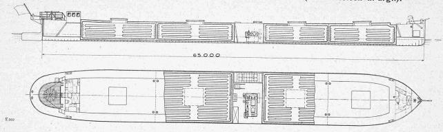
Abb. 2. 600 t-Schleppkahn mit CO<sub>2</sub>-Kühlmaschinen-Anlage. - Entwurf von Escher Wyss & Cie., Zürich. - Masstab 1:400.
