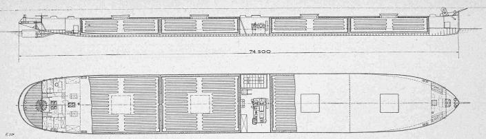
Abb. 1. 1000 & Schleppkahn, mit Motorantrieb und COg-Kühlmaschinen-Anlage. - Entwurf von Escher Wyss & Cie., Zürich. - Masstab 1:400.
