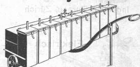
für stündliche Gasleistungen bis zu 50 000 Kubikmeter z. Autogenschweissen im Hoch- und Tiesbau, Eisenbahn- und Brückenbau, Werften, Thermogenarbeiten, Beleuchtungs- und Scheinwerferanlagen usw., nach den Patenten
