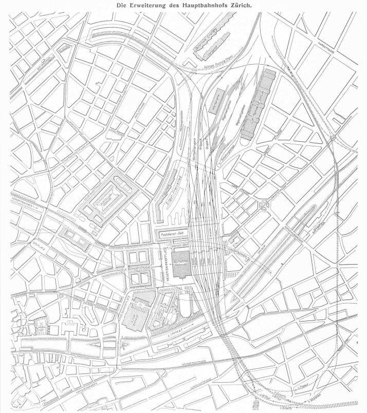
Abb. 35. Experten-Entwurf vom Mai 1919, endgültiger Ausbau mit Vorortbahnlinien im trocken gelegten Sihlbett. — Masstab 1:10 000.
