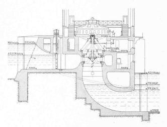
Abb. 28. Schnitt durch das Maschinenhaus des Kraftwerks Eglisau. - 1:400.
