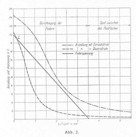
Kraft sinkt im erwähnten Beispiel von 24,5 auf 20,5 t, genügt aber immer noch zur Aufrechterhaltung der Federspannung. Beim Ausschalten des Stromes ist es die in den Federn aufgespeicherte Arbeit, die nebst der dämpfenden Induktionswirkung den Ausrückvorgang bestimmt. Das Ein- und Ausschalten der Kupplung erfolgt vom bequemsten Bedienungsort aus mittels eines zweistufigen Schalters, bei dem durch Ueberbrückung eines Vorschaltwiderstandes die vermehrte Einschaltstromstärke bewirkt wird.
