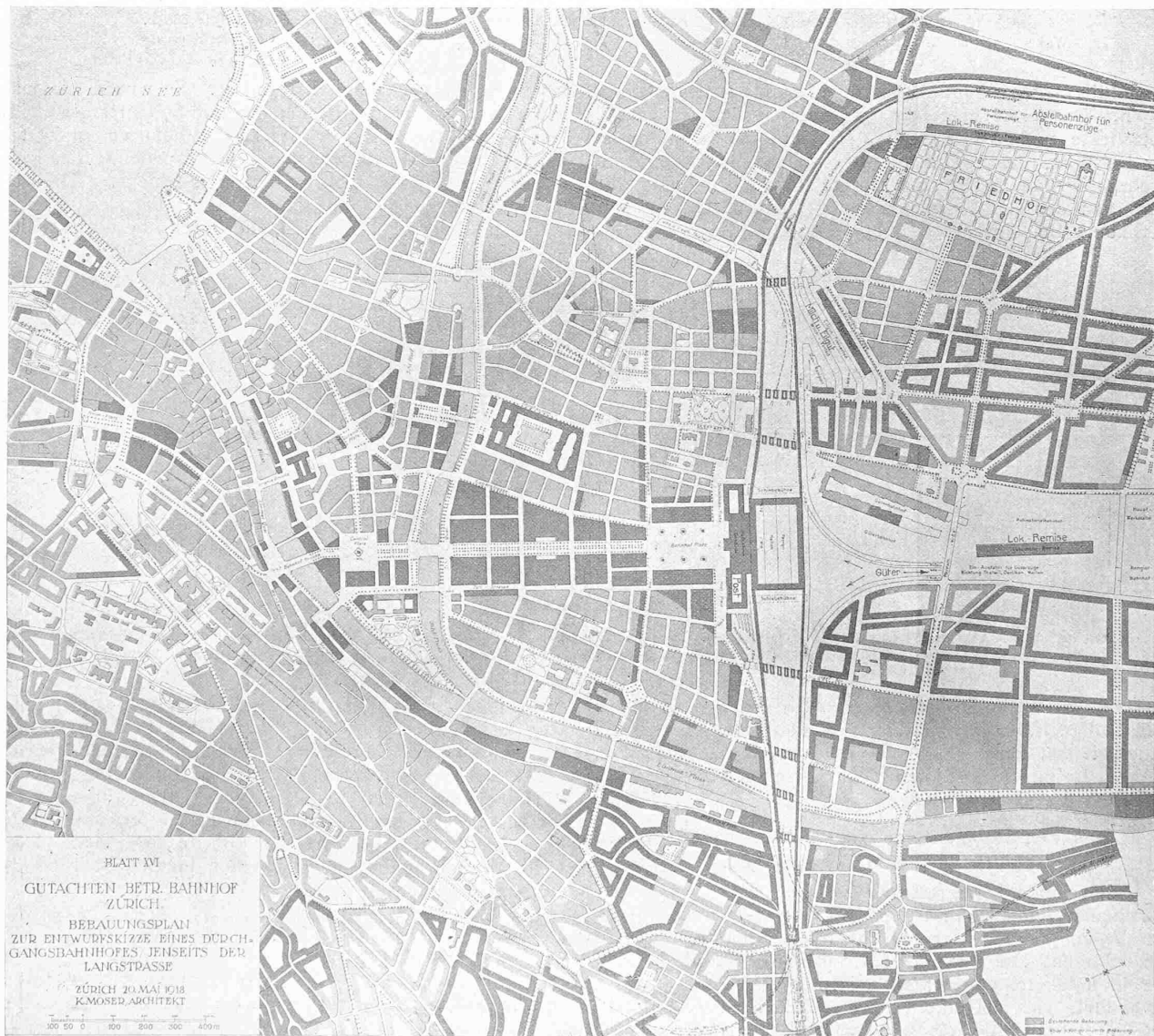
Abb. 25. Vorschlag für Anpassung des Bebauungsplanes an einen hochliegenden Durchgangsbahnhof jenseits der Langstrasse lt. Experten-Gutachten 1918. — 1:20 000.
