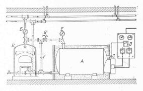
Abb. 19. Warmwasser-Zentralheizung mit Kessel für Koksfeuerung und zugeschaltetem elektrischem Wärmespeicher.
