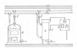
Abb. 18. Warmwasser-Zentralheizung mit Kessel für Koksfeuerung und zugeschaltetem elektrischem Durchlaufkessel.
