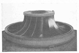
Abb. 13. Laufrad der Turbinen für H = 1.8 m, N = 590 PS, n = 33.
