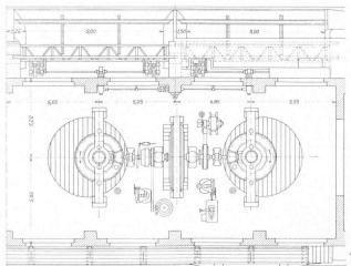
Abb. 6 und 7. Typische Anordnung der Turbinen-Aggregate der drei Mainkraftwerke bei Hanau. — Masstab 1:250.
