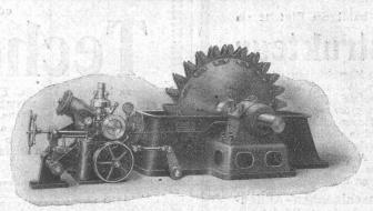
Turbine 4000 HP avec régulateur agissant sur le pointeau et le déflecteur
