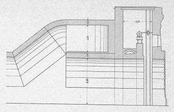
Abb. 17. Einmündung ("Pfeife") des Luftkanals in den Tunnel,"]
