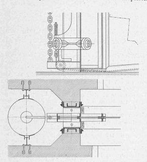
Abb. 19. Rahmenfuss zum Abschluss-Vorhang, darunter: Horizontalschnitt. — Masstab 1:30.
