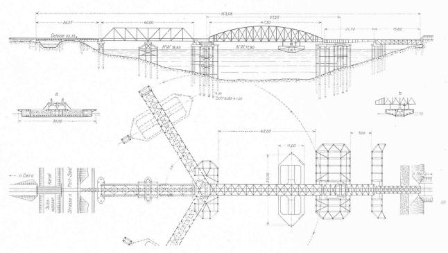
Schwing- und Drehbrücke über den Suez-Kanal bei Kantara. Aufriss und Grundriss, sowie Schnitte durch den Schwimmponton. — 1:1000.
