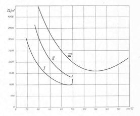
Abb. 5. Verlauf des spezifischen Widerstandes des Wassers mit steigender Temperatur.
