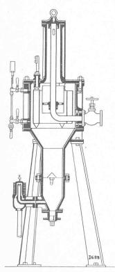
Abb. 7. Elektrodenkessel, System Revel.
