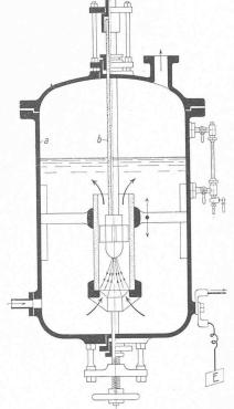
Abb. 8. Elektrodenkessel mit Röhrenregulierung, System Brown, Boveri % Cie , Baden.  $a = \text{Metall}; \ b = \text{Isolierung}.$
