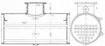
Abb. 1. Gewöhnlicher Siederöhren-Kessel mit elektrischer Heizung.
