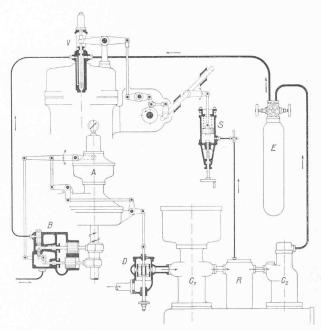
Abb. 5. Schema der Regulierung des Dieselmotors.
