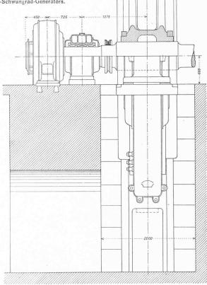
Abb. 10. Schnitt durch den Drehstrom-Generator von 2200 kVA, 125 Uml/min.
