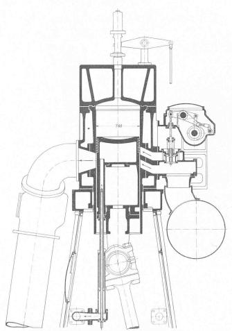
Abb. 4. Schnitt durch einen Arbeits-Zylinder des Motors. - 1:40.
