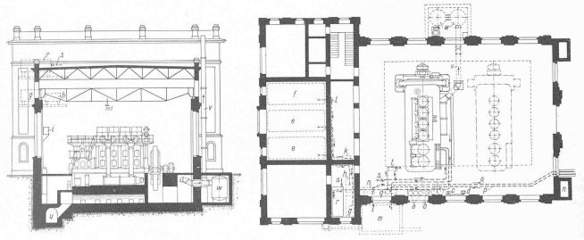
Abb. 7 und 8. Vertikalschnitt und Grundriss des Reservekraftwerks mit Bezeichnung der Hülfseinrichtungen. -- Masstab 1:400.
