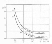
Abb. 11. Brennstoff-Verbrauch des Dieselmotors.
