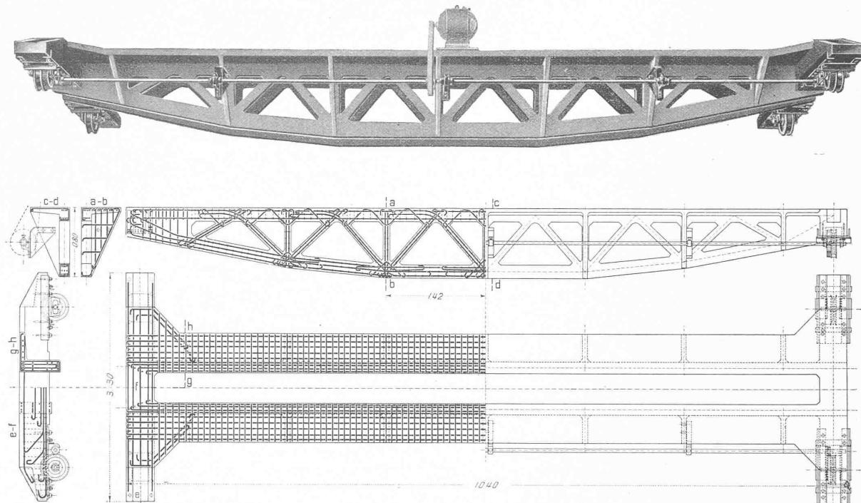
Laufkran-Träger in Eisenbeton von 10 m Spannweite für 3 t Tragkraft. — Ansicht, sowie Schnitte mit Armierungsplan im Maßstab 1:65.
