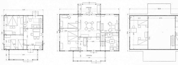
Abb. 23. Grundriss-Typ 56  $m^2$ . — Masstab 1:200. — Abb. 24 und 25. Grundriss-Typ 90  $m^2$  überbauter Grundfläche.
