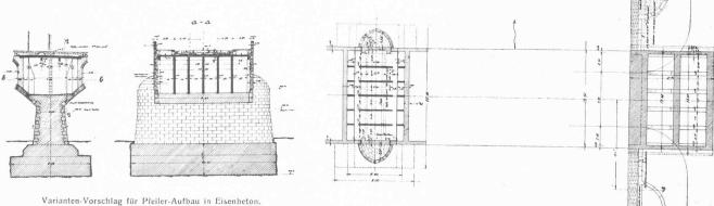
Varianten-Vorschlag für Pfeiler-Aufbau in Eisenbeton. Längs-, Quer- und Horizontal-Schnitt 1:500.
