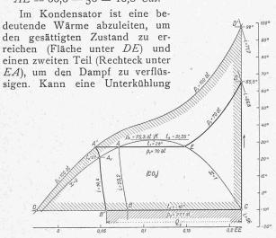
nicht stattfinden, so trägt der Stoff die Flüssigkeitswärme i = 23.2 Cal durch das Drosselventil in den Verdampfer (AB), wo die Kälteleistung  $Q_2 = 56 - 23.2 = 32.8$  Cal entsteht.
